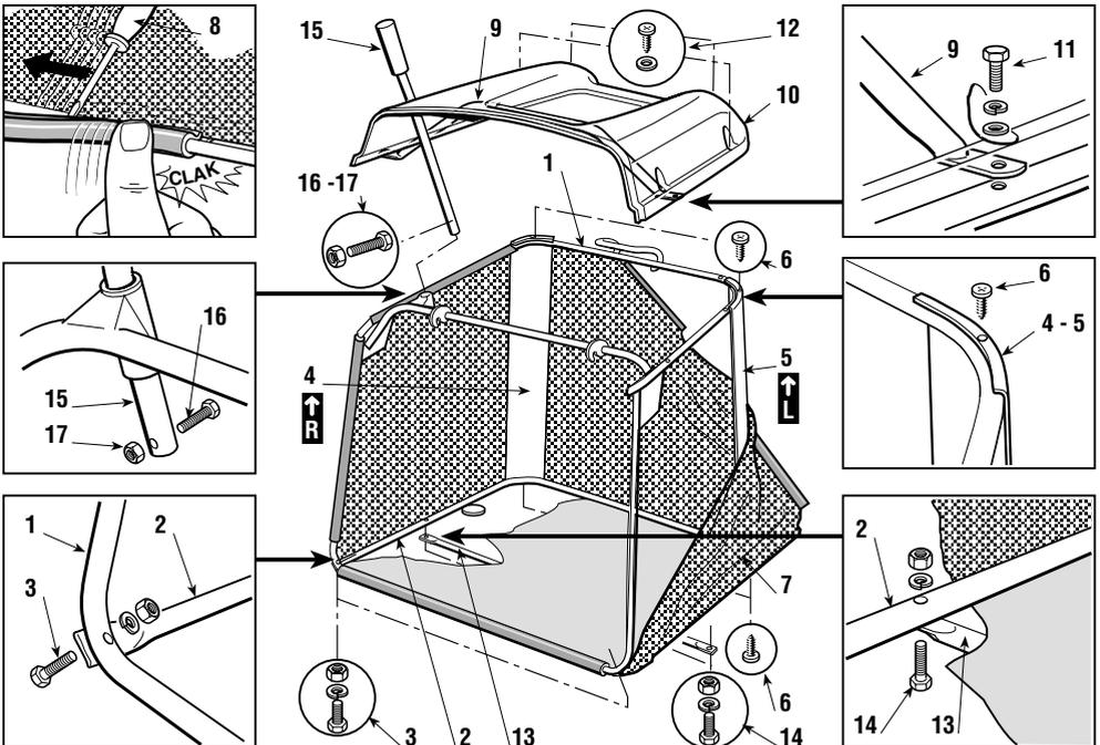
d'angle (4) et (5) d'après le marquage de la droite (R ↑) et de la gauche (L ↑), les fixer au châssis par quatre vis autotaraudeuses (6).
