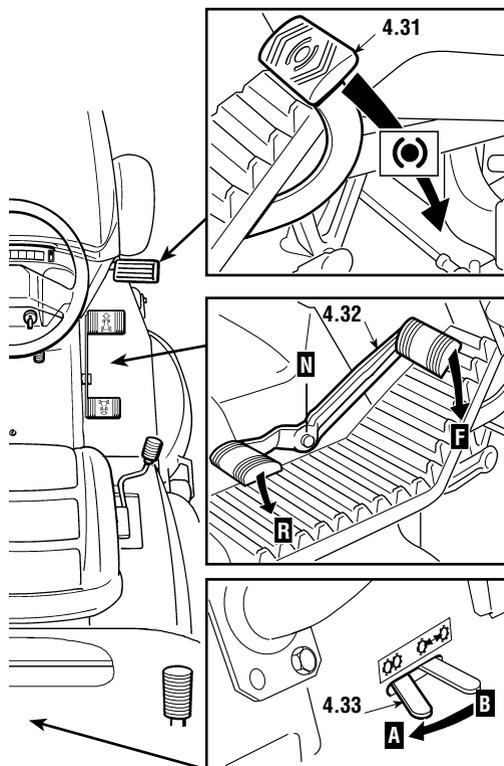
**⚠ ATTENTION!** *Le passage de la marche arrière doit être effectué quand la machine est à l'arrêt.*
