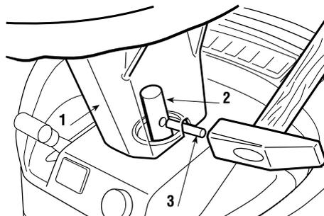
Faire correspondre le trou prévu dans l'axe du volant avec celui de la colonne de direction pour pouvoir y introduire le goujon blocage (3) fourni à l'aide d'un marteau et s'assurer qu'il traverse bien.
