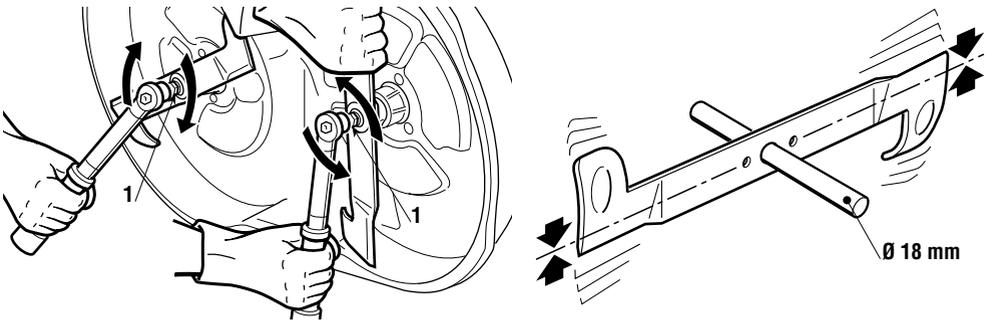
sens indiqué par flèche pour chaque lame, car les vis de fixation sont l'une à filet droit et l'autre à filet gauche.
