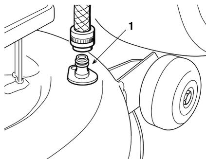
Relier alternativement un tuyau d'arrosage aux raccords prévus à cet effet (1) et faire couler l'eau pendant quelques minutes dans chacun, avec les lames en mouvement.
