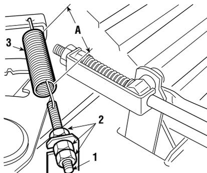
**A** = 114 - 116 mm (▶ dans les modèles à transmission mécanique)
