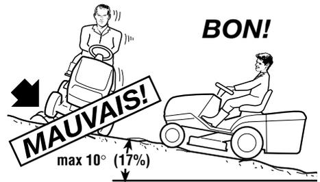
**⚠ DANGER!** *REDUIRE LA VITESSE AVANT TOUT CHANGEMENT DE DIRECTION EN PENTE et ne pas oublier d'enclencher le frein de stationnement avant de laisser la machine à l'arrêt et sans surveillance.*
