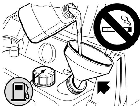
riques indiquées dans le manuel du moteur, il doit se trouver entre les encoches MIN et MAX de la jauge.
